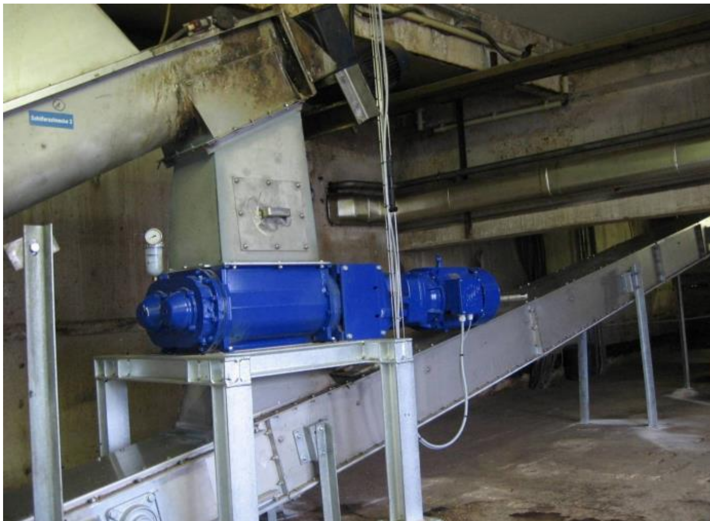
XRipper alimentazione tramite coclea . Evacuazione tramite nastro trasportatore.
