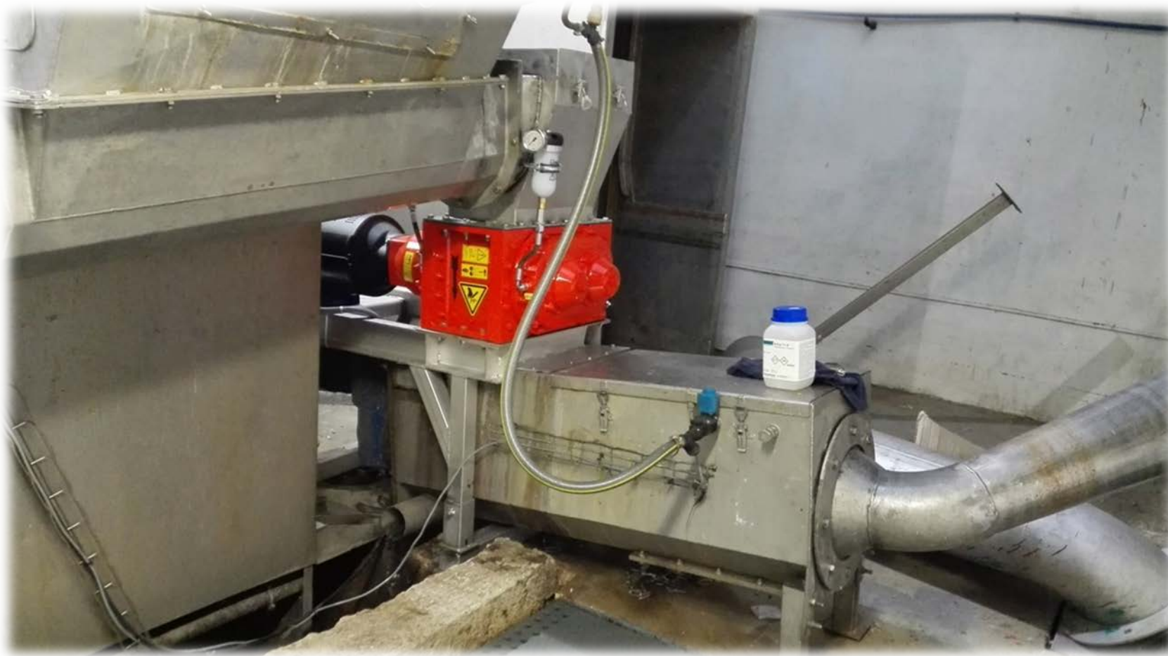
XRipper alimentazione tramite coclea. Espulsione tramite coclea di drenaggio
